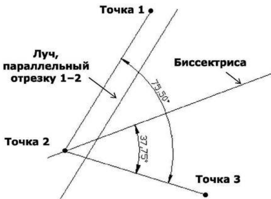
Рис. 5.2. Построение биссектрисы угла
